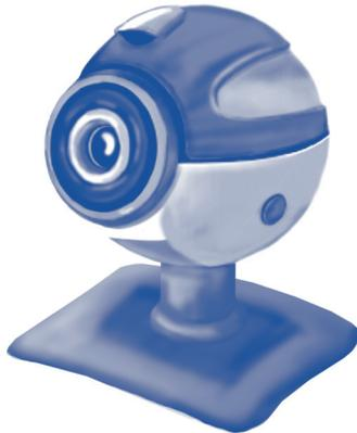
**Webcam:** Cámara para la transmisión de la señal de video, con tamaños de imágenes de VGA 640 x 480 píxeles, con velocidad de cuadros: 30 fps (352 x 288) y 20 fps (640 x 480). Algunas pueden hacer funciones de cámara de fotos.
